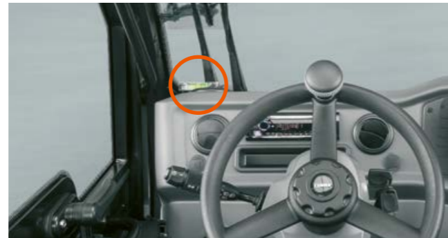
Wasserwaage in der Kabine
