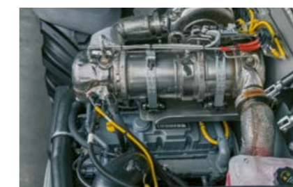
Der Dieselpartikelfilter regeneriert automatisch.
