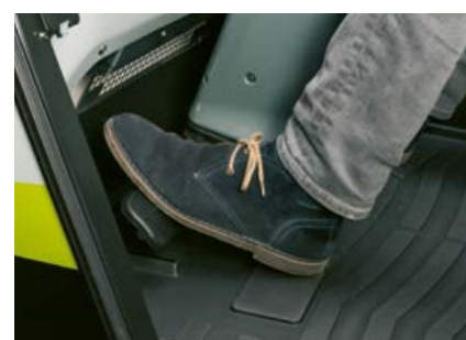
Das Bremspedal mit Inchfunktion reduziert Kraftstoffverbrauch und Bremsenverschleiß.
