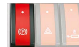
Mit dem Kippschalter kann die Feststellbremse manuell aktiviert werden.
