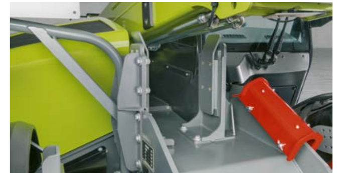
Seitliche Teleskoparmführung verfügbar für alle SCORPION Modelle
