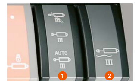
1 Steuerkreis vorn 2 Druckentlastung
