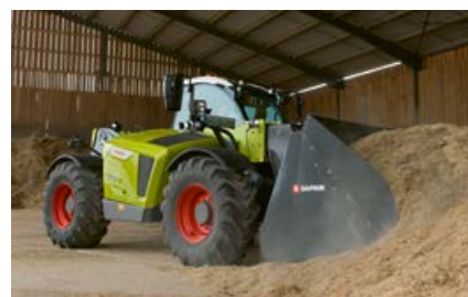
Automatische Schaufelrückführung für schnelleres Arbeiten in Bodennähe
