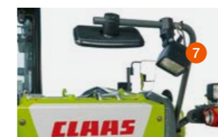
Halogenscheinwerfer am Halter des Heckspiegels zur Ausleuchtung des Rückraums
