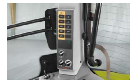
Zapfwellengeschwindigkeiten und elektronische Kraftheberregelung am B-Holm einstellbar
