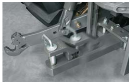
Die Zuggendelvarianten bieten mehrere Positionen. Die ausgezogene Position ermöglicht eine bessere Wendigkeit.
