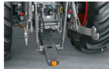
Eine Hitchhakenkupplung ist alternativ zum ISO-500-konformen Anhängenock erhältlich.
