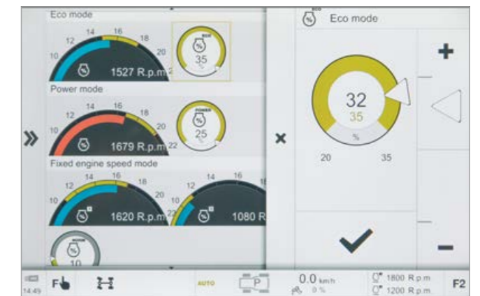
Einstellung der Motordrücke für „Eco“ und „Power“, sowie den Motordrehzahlsspeicher.
