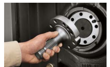
Einfacher Wechsel der Zapfwellenstummel
